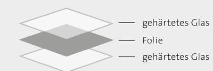
Speziell wärmebehandeltes Glas mit erhöhter Stoß- und Schlagfestigkeit. Im Falle eines Bruchs entstehen kleine, kieselsteingroße Bruchstücke.
